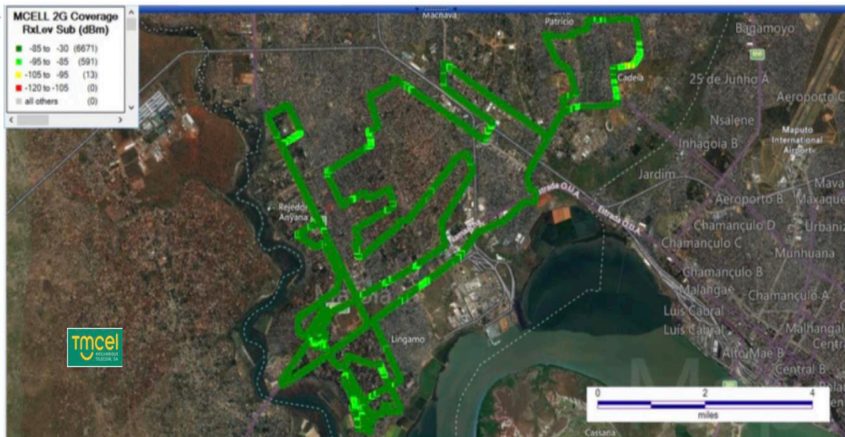
Figura 20. Representação da cobertura 2G da Tmcel, S.A na Cidade da Matola
