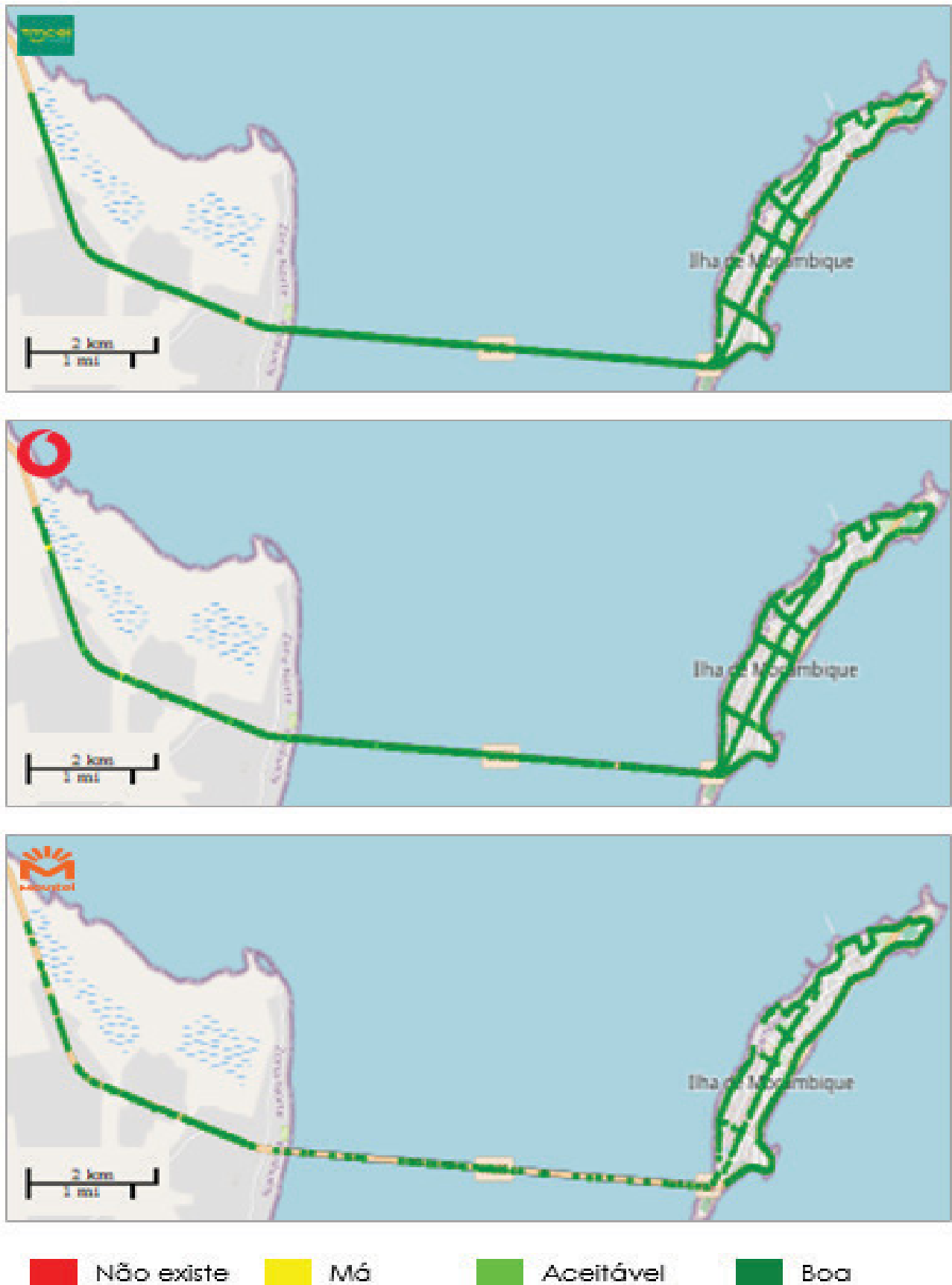
Figura 26. Representação da Cobertura 2G para Tmcel, Vodacom, Movitel – (29 Novembro de 2023)
